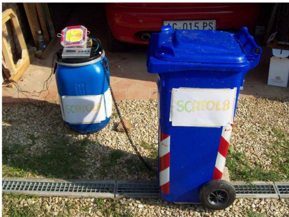
Figura 24: Esempio di monitoraggio quantitativo della produzione di rifiuti. Applicazione di “Scatol8” per la pesatura di un carrellato per la raccolta differenziata. Fonte: [www.scatol8.net](http://www.scatol8.net)
