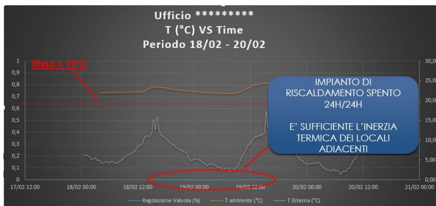
Figure 17: **Esempio di buon utilizzo del Termostato**
